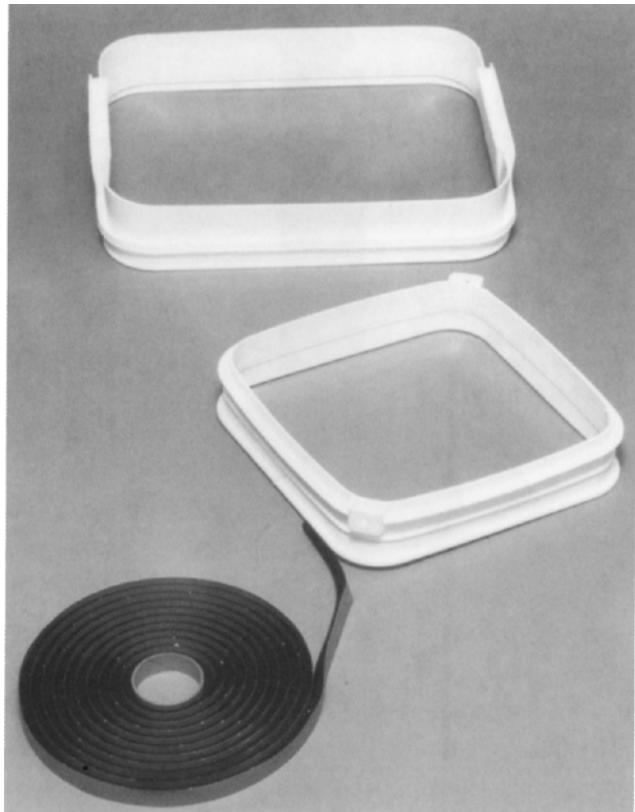
UNISORB灌漿模設計用於減少設備安裝底座澆築灌漿材料所需的時間。使用簡便的塑料水泥模省去了現場模具製做程序，同時還保證所澆築成形的水泥底部具有一致的尺寸、形狀和厚度。灰漿凝固後，只需用刀將塑料模割開便可輕鬆拆除模子。可提供尺寸為9"和11"的方形水泥模。也可提供12" x 15" 的矩形模。9" 模的高度在8" 以內，設計成與 UNISORB RK-1型 Fixator配套使用。11"模的高度在10"以內，與RK-II，RK-III型Fitator配套使用。可提供高度在11"以內的12" x15"的模子，與RK-IV及RK-V Fixator配套使用。
