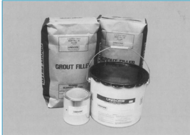
深孔型V-100樹脂水泥漿用於涉及最大橫切面、允許最低停機時間的灌漿應用。樹脂及水泥漿的澆築深度可達203mm，具有很高的流動性而又不降低其安裝強度。深澆築灰漿在很大程度上比水泥質材料更耐油，耐油脂，耐酸，耐鹼。其抗拉強度和彎曲強度至少可達混凝土的11倍，抗壓強度可達混凝土的4倍。
