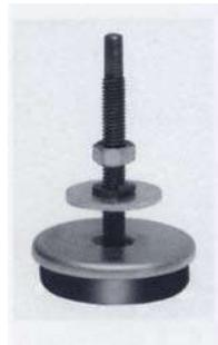
LR-200、LR-500是專為輕型設備應用而設計的產品。LR-200用於100kg以下的安裝載荷，LR-500用於220kg以下的載荷。兩個型號均配有鋼制底座、彈性隔離墊及內置校正螺絲。
